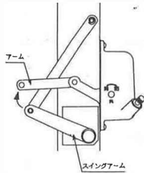
③ ねじを外してオペレーターを外して下さい。
