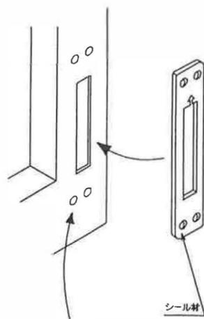
② オペレーターをねじで取付けて下さい。
