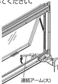
② 連結アーム(大)先端のピンを、障子側金具の円形部へ挿入してください。
