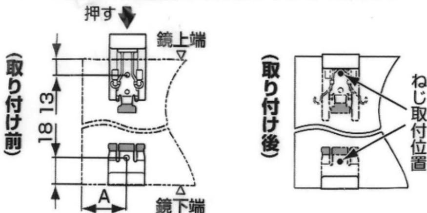
取付完了後:上側取付金具が最後まで下がっているか確認してください。
