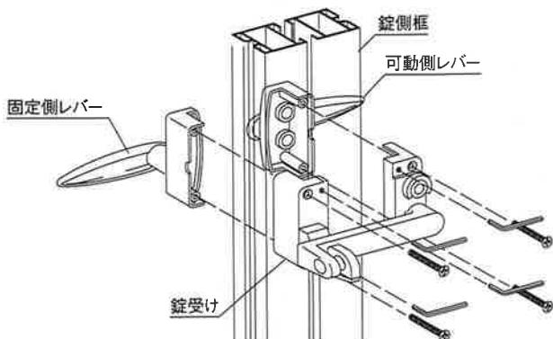
※皿小ねじで取り付け後、六角穴付ねじを締めて、錠側框に固定してください。
