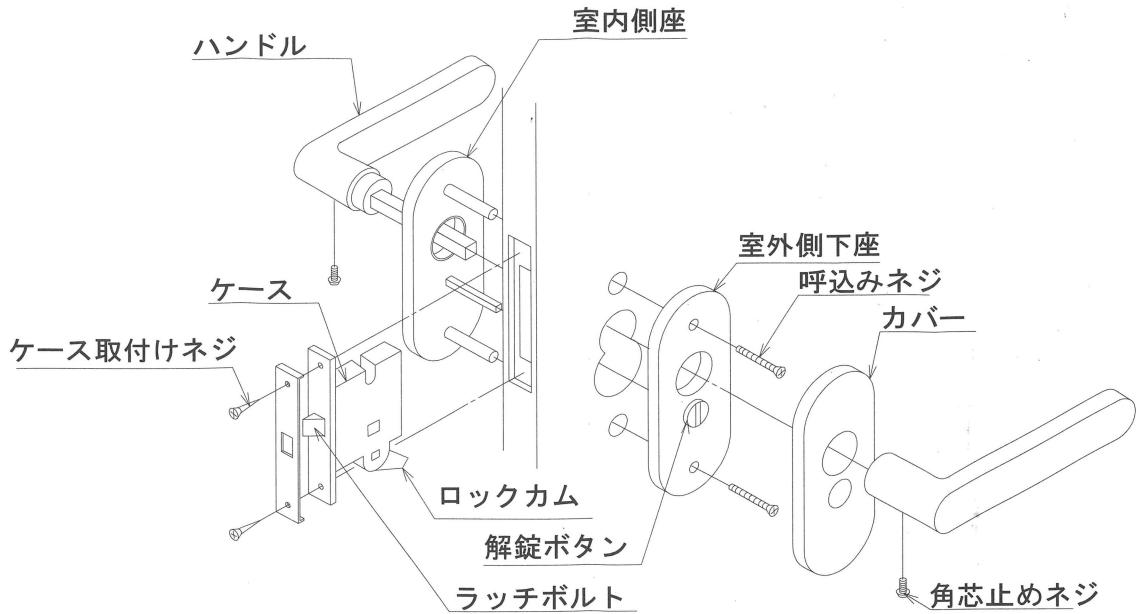
**注意** ねじ締めの際、締め過ぎに注意し電気ドライバーは使用しないでください。
