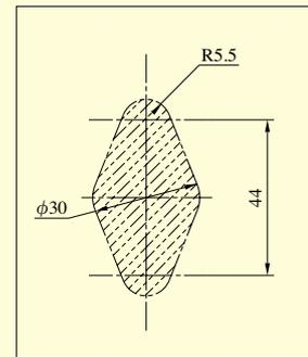
ノブ形状 (M、E、D、W、U型はBM型の押ボタン付ノブを示す)
