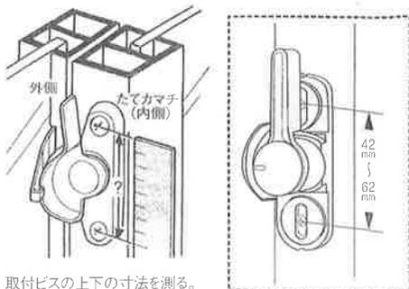
取付ビスの上下の寸法を測る。
